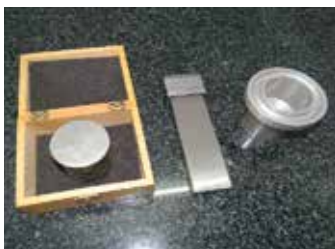
CỐC ĐO TỶ TRỌNG, THƯỚC ĐO ĐỘ MỊN, CỐC ĐO ĐỘ DENSITY MEASURING CUP, SMOOTH MEASURE, LEVEL MEASURING CUP
